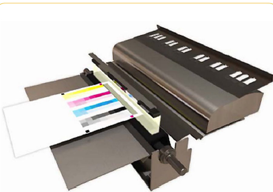
Inline senzor Full Width Array zajišťuje tři funkce, které automatizují jinak časově náročné úkony při nastavení tisku: základní nastavení barev, předozadní registrace a správu barev prostřednictvím sady ACQS.
